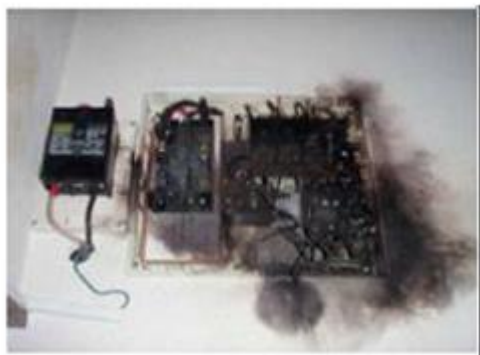
写真3 分電盤の被害様相
